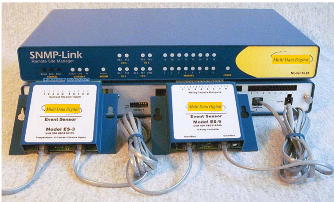
Eventsensor ES-3 und ES-9 an ein SL61 angeschlossen
